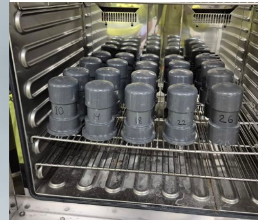
▲ Olika bindemedel genomgår hållfasthetsprov i klimatskåpet ◀ Pastahuset.
