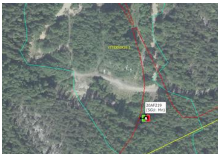
Figur 6-20. Provtagningspunkt och analysresultat för petroleumämnen och metaller i grundvattnet inom det tidigare täktområdet.
