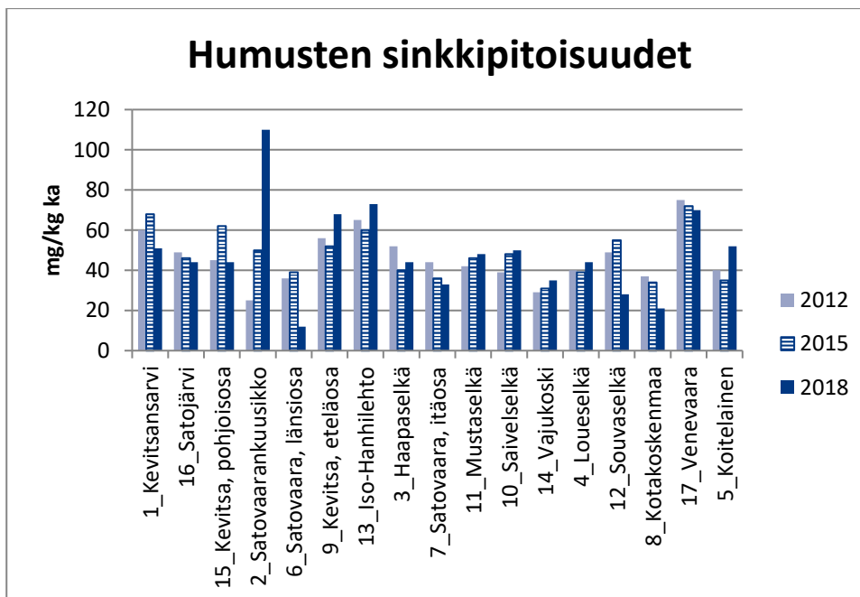
Kuva 3-15. Humusnäytteiden sinkkipitoisuudet, louhoksen keskiosasta loittonevassa järjestyksessä.
