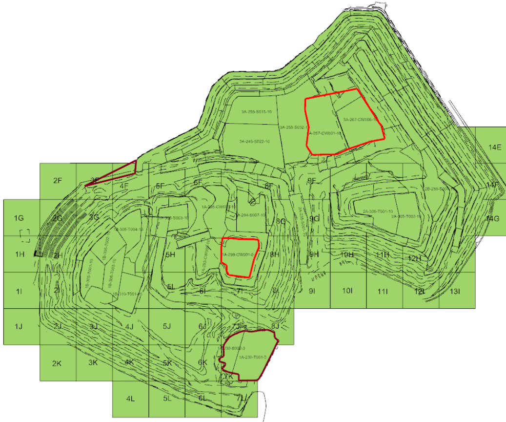
Kuva 3-1. Vuonna 2023 käytössä olleet sivukiven läjitysalueet (vihreällä) ja kapseloitavan kiven sijoituspaikat (punaisella rajatut alueet). Vuoden 2023 valmistuneet laajennusalueiden pohjatytöt on rajattu ruskealla.
