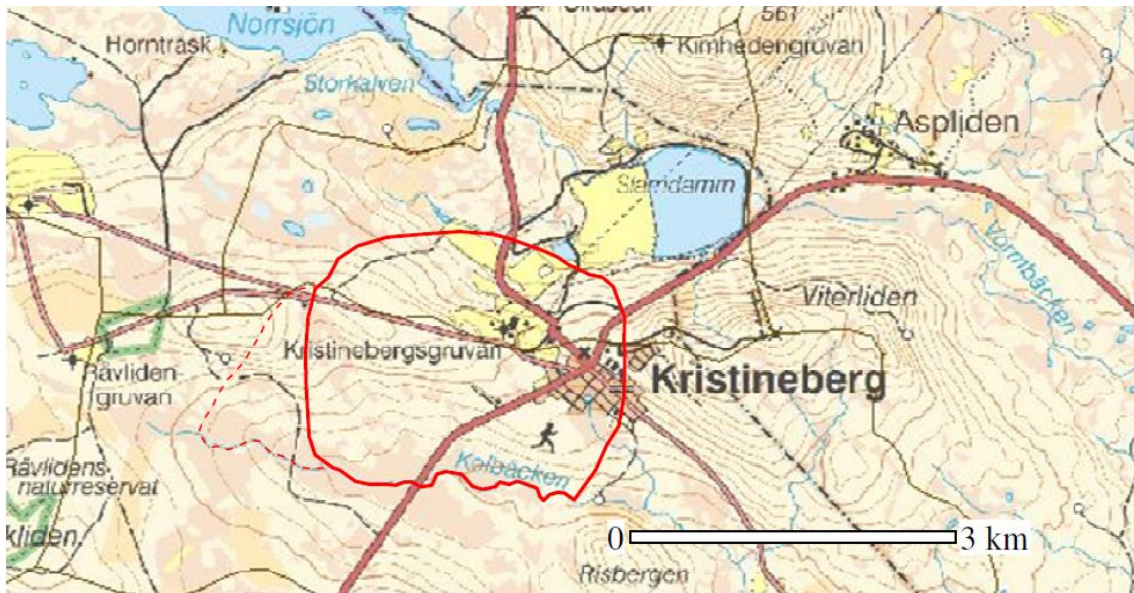
Figur 7. Det uppskattade influensområdet som omger Kristinebergsgruvan i dag (röd heldragen linje), samt bedömd maximal utökning av influensområdet under framtida brytning ned till 1350 meter nivå (röd streckad linje). Bilden är hämtad från den geohydrologiska utredningen som gjordes inom ramen för miljötilståndet.
